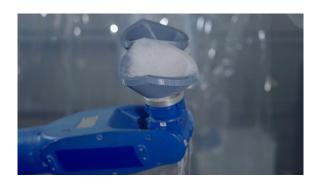
3) ロボットの動きによって吹付口からの距離や吹き付ける場所、時間を変化させることで立体的に成型する
